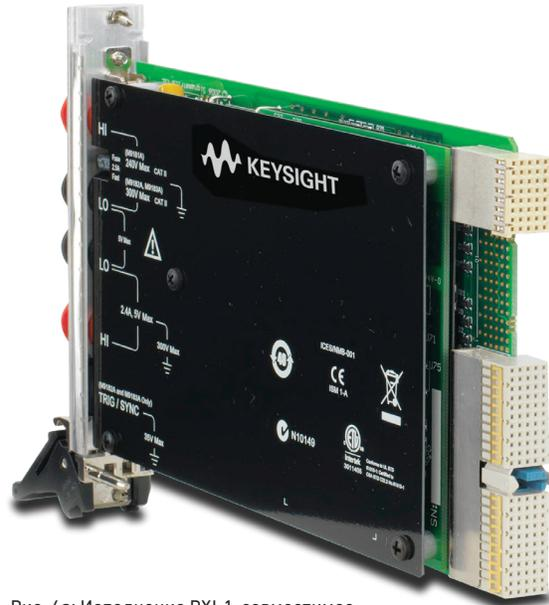
Рис. 4а: Исполнение PXI-1, совместимое с гибридным слотом
