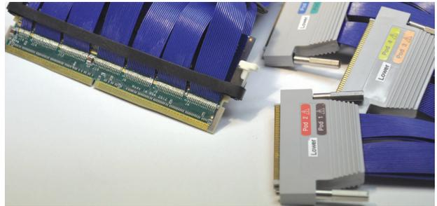
Рис. 6. Интерпозер DDR4 DIMM.
