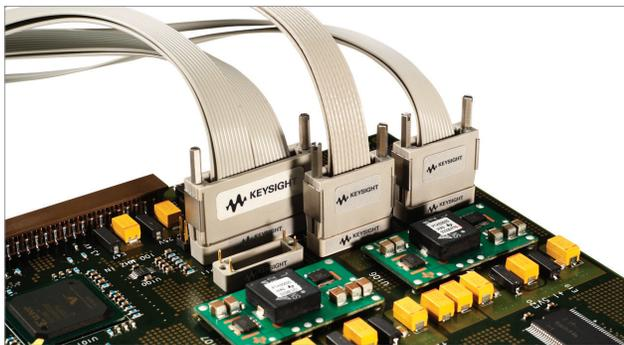
Рис. 5. Зонды Keysight Soft Touch для логического анализатора.
