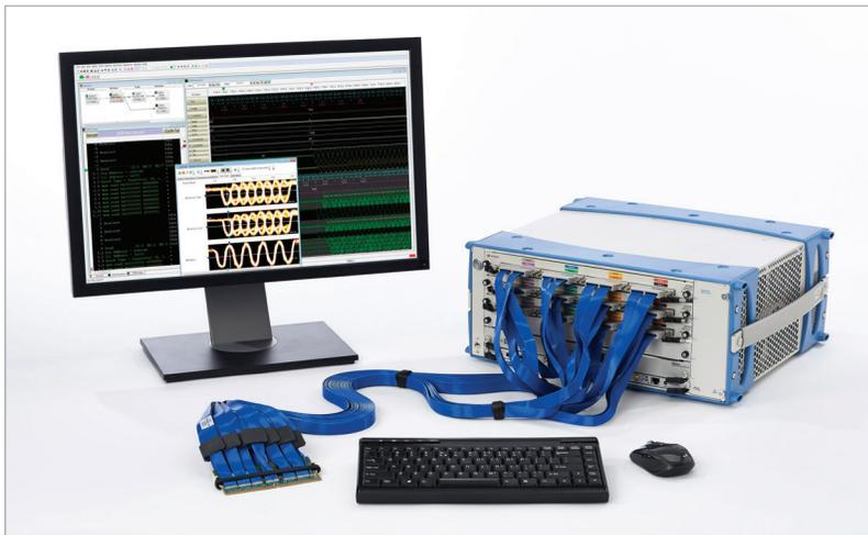
Рис. 1. Модульная система логического анализатора U4154B в режиме состояний на скорости 4 Гбит/с в конфигурации с интерпозером FS2510AB DDR4 DIMM, предназначенная для анализа микросхем памяти DDR4 DIMM на скоростях свыше 2,5 Гбит/с и доказавшая свою работоспособность на скоростях выше 3,1 Гбит/с.
