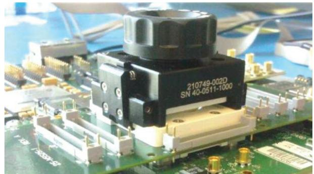
Рис. 9. Специализированные зонды Keysight.
