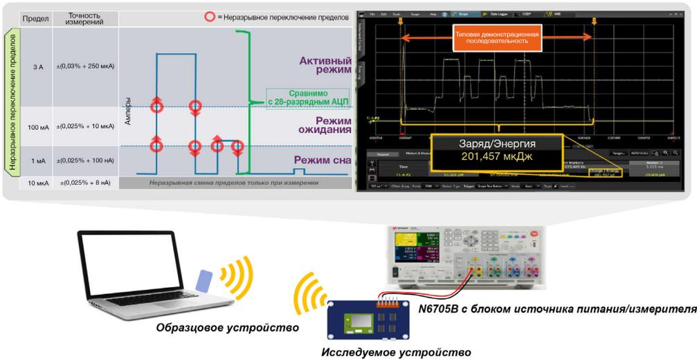
Рис. 10. Анализатор питания постоянного тока производит динамический анализ потребления мощности, помогающий выяснить, как расходуется энергия батареи, и понять требования к электропитанию.
