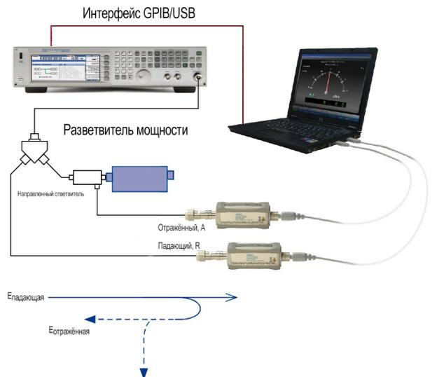
Рисунок 4 - Установка для измерения параметров отражения
