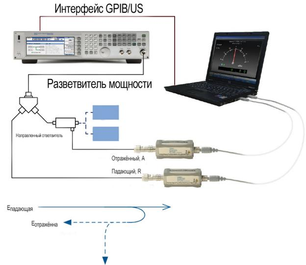
Рисунок 3 - Установка для калибровки измерения параметров отражения
