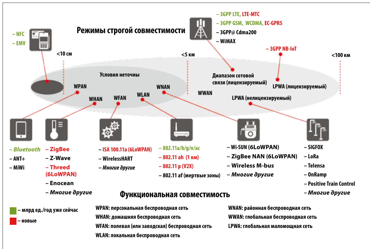
Рис. 2. Предполагаемый радиус действия устройств IoT непосредственно влияет на выбор технологии подключения
