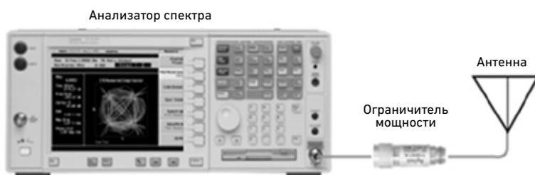
Рис. 2. Типичное использование ограничителя мощности для защиты ВЧ прибора. Вход анализатора спектра защищен от непреднамеренной перегрузки при поступлении сигналов высокого уровня от антенны.
