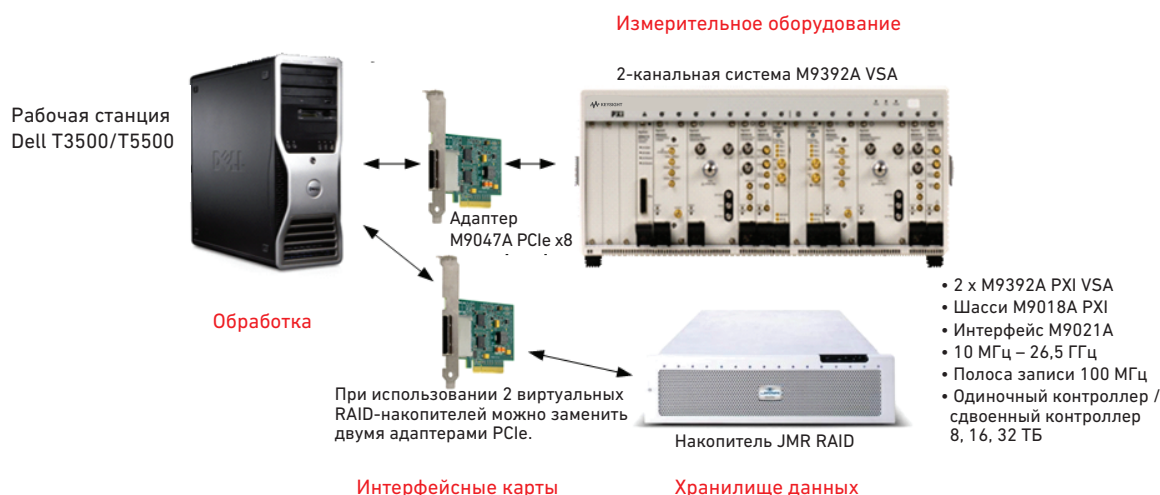
Рис. 5. Решение Keysight с накопителем ёмкостью 32 ТБ для записи ВЧ сигнала. В состав системы входят интерфейсные карты и модули с широкополосным и высокопроизводительным интерфейсом PCIe.
