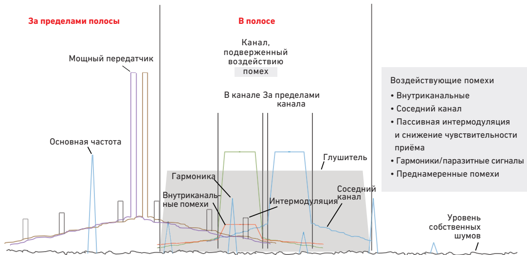
Рис. 11. Здесь показаны разные формы помех и их влияние на приёмник.
