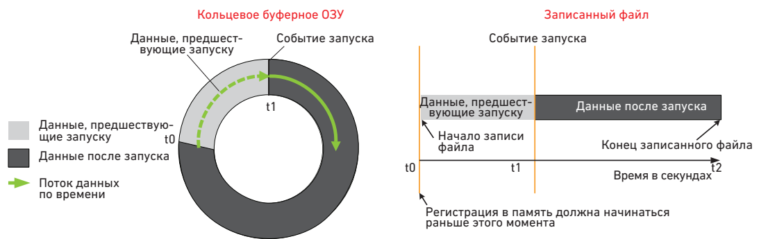
Рис. 6. Процесс непрерывной записи в решении M9392A. Данные из памяти ПК с очень большой скоростью записываются в RAID-массив. RAID-массив применяется потому, что один жёсткий диск не может сохранять данные с требуемой непрерывной скоростью.
