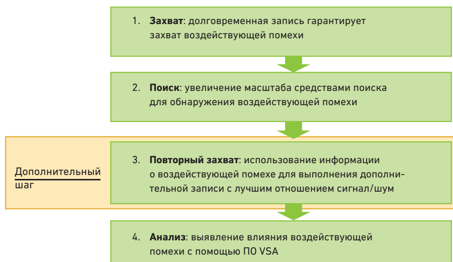
Рис. 12. Этот структурированный процесс облегчает анализ радиочастотной среды.
