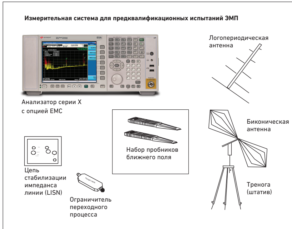
Рисунок 3. Компоненты системы для предварительной оценки уровня помех
