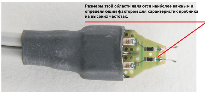
Рисунок 2. Увеличенное изображение впаиваемой головки пробника InfiniiMax
