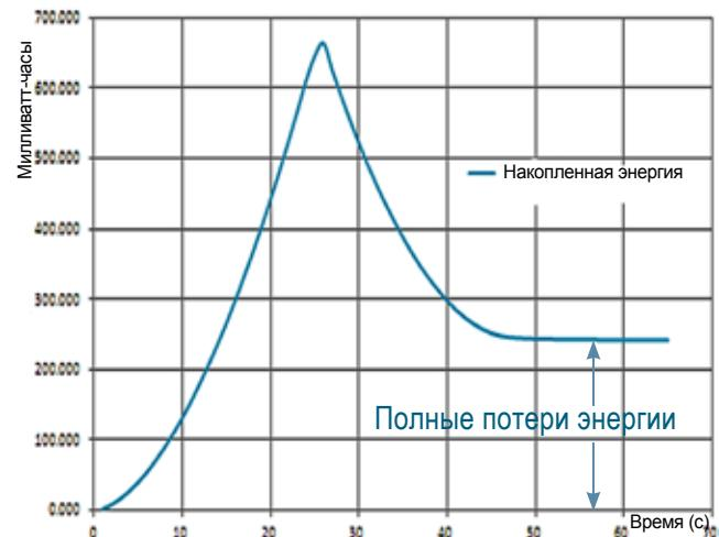
Рисунок 9. Процесс накопления и расходования энергии суперконденсатором
