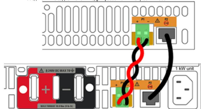
Соединения на задней панели источника питания постоянного тока семейства APS
