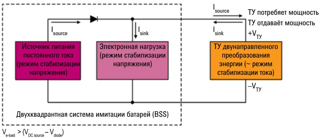
ТУ потребляет мощность (активен источник питания постоянного тока):  $V_{TY} = (V_{DC\ source} - V_{diode})$
