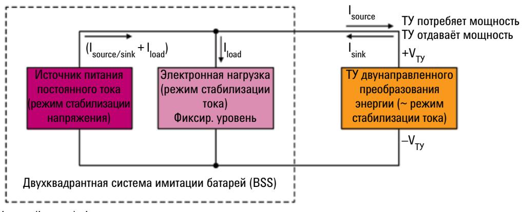
$$\text{ТУ потребляет мощность: } I_{DC source} = (I_{source} + I_{load})$$
