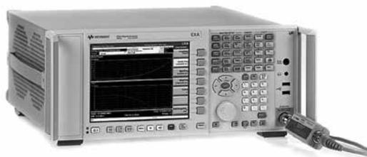
Анализатор сигналов серии X с источником шума серии SNS
