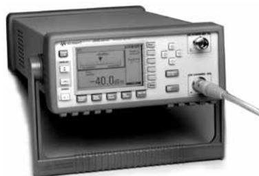
Измеритель мощности серии EPM
