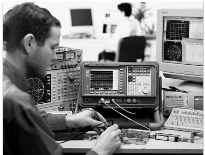
*Анализатор шумов (NFA) упрощает измерение коэффициента шума*
