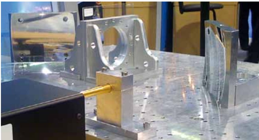
Рис. 22. Квазиоптический стол Thomas Keating Ltd. с диапазоном частот 330-500 ГГц, рупорные антенны с гауссовской диаграммой направленности, фокусирующие зеркала и держатель образца.
