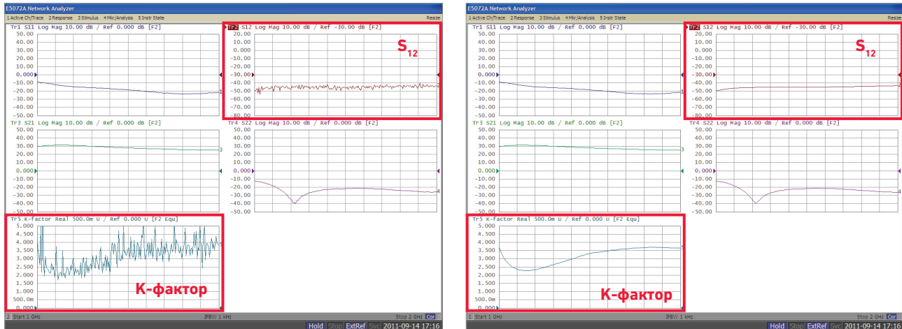
Рис. 3. Сравнение результатов измерений, полученных с использованием схемы с развязкой по питанию (справа) и без развязки по питанию (слева).
