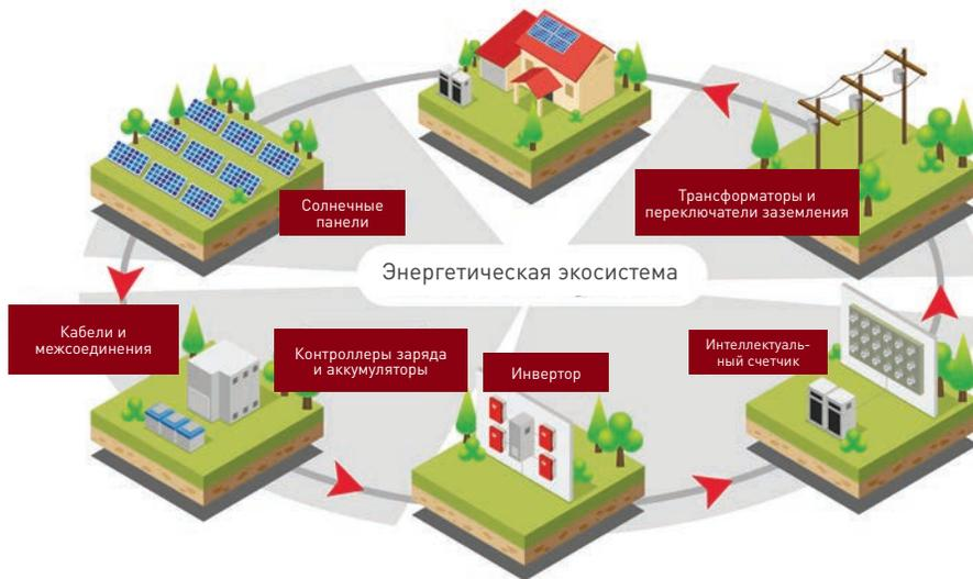
Рис. 2. Компоненты солнечной фотогальванической системы.
