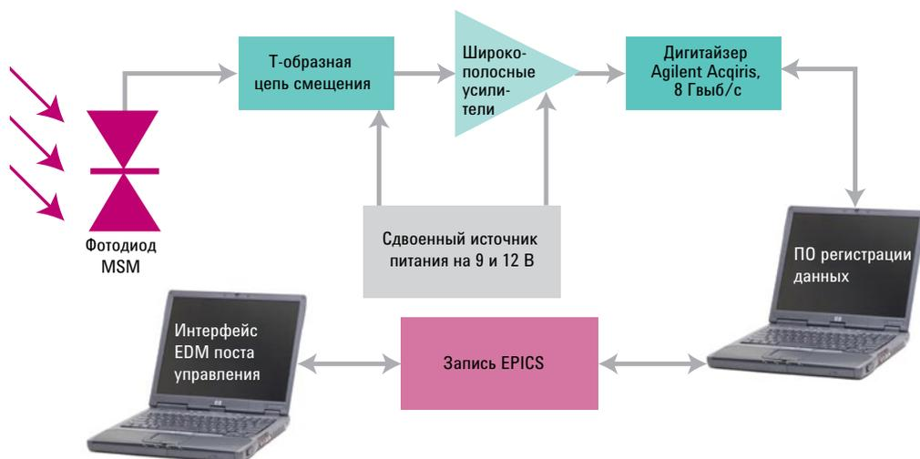
Рис. 7. Схема экспериментальной установки для измерения шаблона заполнения.
