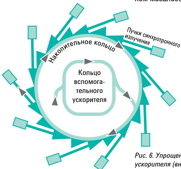
Рис. 6. Упрощенная схема Австралийского синхротрона: кольцо вспомогательного ускорителя (внутреннее) питает накопительное кольцо (внешнее) и пучки синхротронного излучения (ответвления накопительного кольца).
