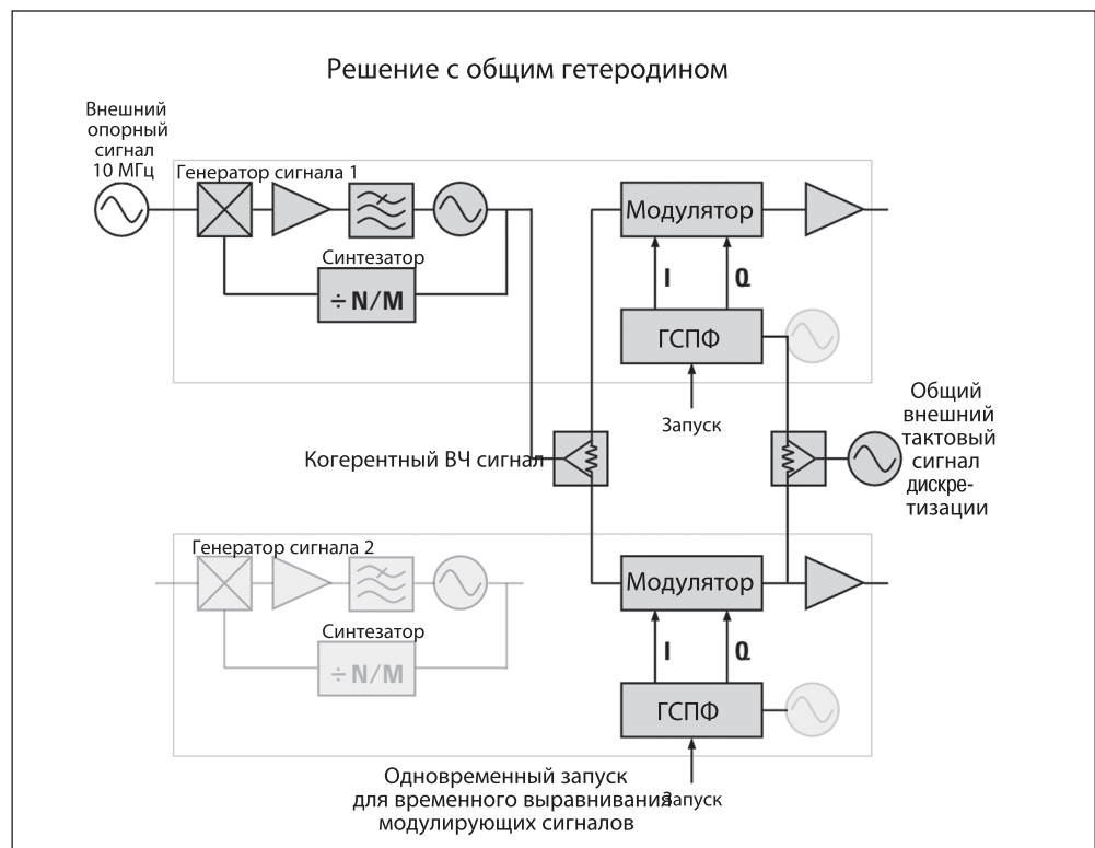
Рисунок 9. Совместное использование общего гетеродина генераторами сигналов эффективно исключает фазовую ошибку между сигналами и обеспечивает полную фазовую когерентность. В качестве гетеродина может использоваться внешний источник или сигнал "ведущего гетеродина" одного из приборов, распределённый между другими приборами.
