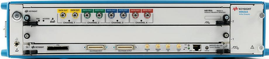
Рисунок 17. Генератор M8195A представляет собой 8-разрядный ГСПФ с частотой дискретизации до 65 ГГц и аналоговой полосой частот до 20 ГГц.
