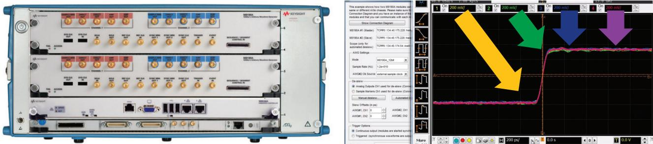
Рисунок 18. Генератор M8190A компании Keysight имеет частоту дискретизации 12 Гвыб/с и является ГСПФ с высоким разрешением (до 14 бит). Он может обеспечить до 12 синхронных каналов формирования сигналов и регулировку временных параметров с шагом менее 1 нс, что является важной возможностью при имитации многоканальных сценариев. Справа показана синхронизация четырех каналов генератора с одинаковыми уровнями на экране четырехканального осциллографа.
