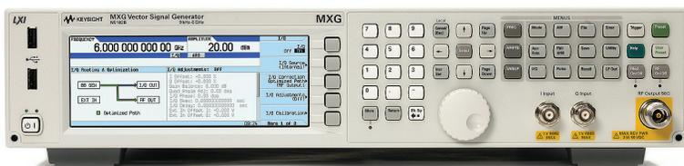
Рисунок 12. Векторный генератор сигналов серии MXG N5182B компании Keysight способен формировать сигналы на частотах до 6 ГГц с полосой частот модулирующего сигнала до 160 МГц. Он также имеет возможность совместной работы с несколькими генераторами серии MXG для одновременного создания нескольких когерентных сигналов для решения многоканальных прикладных задач.
