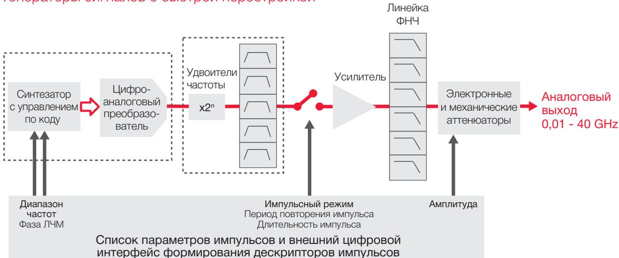
Рисунок 7. Типовая структурная схема генератора с быстрой перестройкой.
