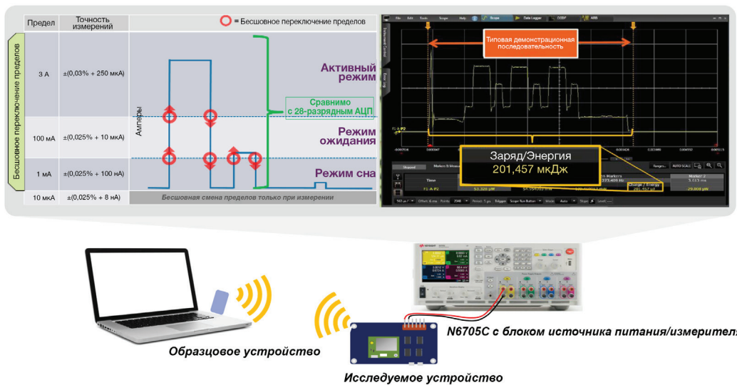
Рис. 4. Анализатор питания постоянного тока производит динамический анализ потребления мощности, помогающий выяснить, как расходуется энергия батареи, и понять требования к электропитанию.
