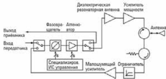
Рисунок 2 – T/R модули являются главными связующими устройствами между антенной РЛС и приёмником. Активные компоненты – фазовращатели и переменные аттенюаторы требуют испытания в нескольких состояниях.
