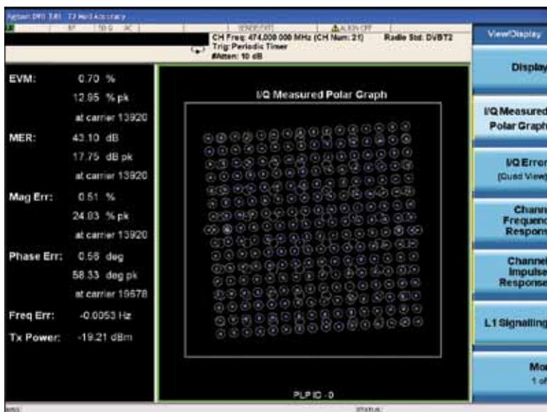
Рис. 25. Представление измерения I/Q в полярных координатах
