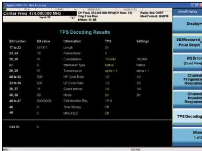
Рис. 20. Измерение точности модуляции с представлением декодирования TPS
