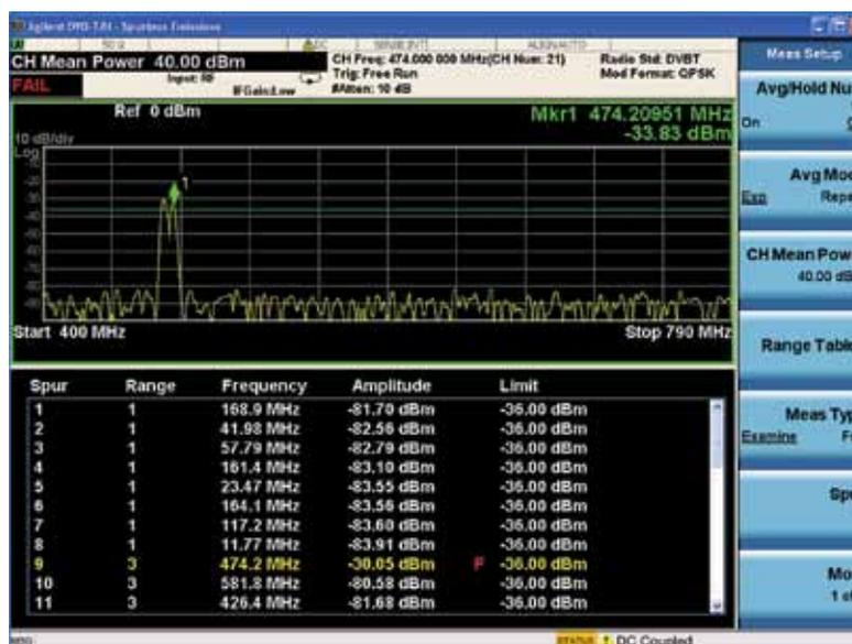
Рис. 32. Измерение паразитных излучений
