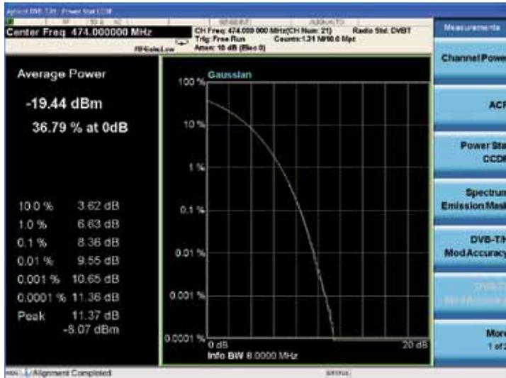
Рис. 12. Измерение комплементарной интегральной функции распределения мощности
