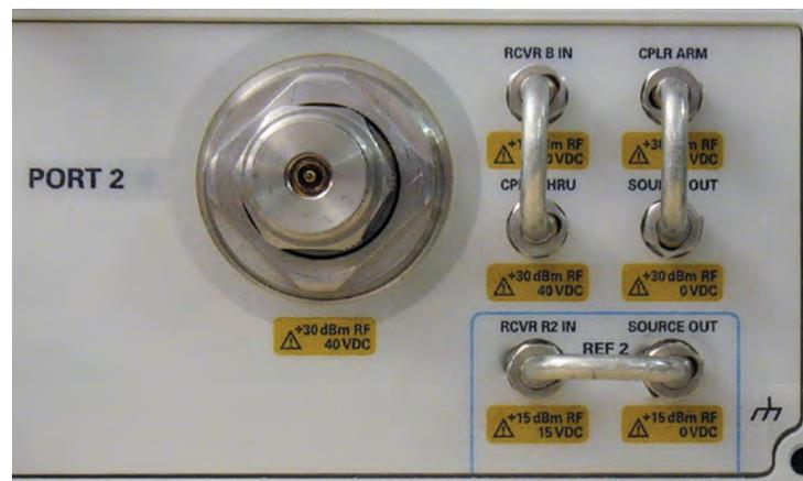
Рисунок 30 - Размещение кабельных перемычек для включения направленного ответвителя измерительного порта в обратном направлении (прямой и ответвлённый каналы поменялись местами).
