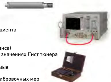
Рисунок 39 - Обзор векторной калибровки шума, использующей малошумящие приёмники и механический калибровочный комплект для калибровки S-параметров.
