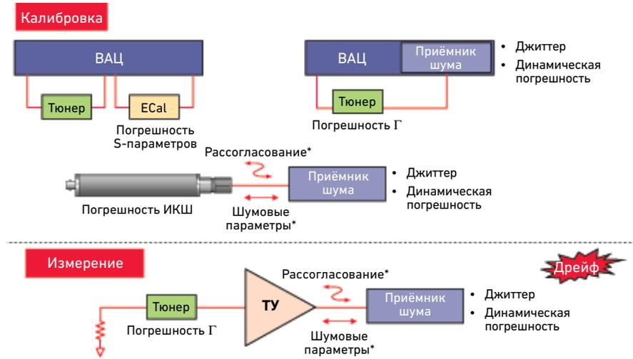
\* Методы векторной коррекции ошибок и коррекции согласования в источнике, используемые PNA-X, значительно снижают погрешности, обусловленные рассогласованием и шумовыми параметрами, в сравнении с методом Y-фактора.
