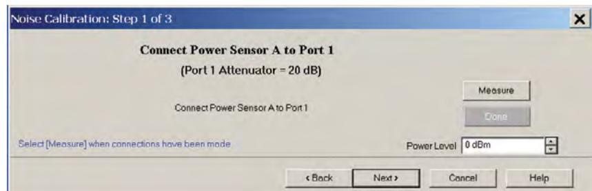
Рисунок 48 - При использовании измерителя мощности во время калибровки уровень мощности может быть оптимизирован независимо от уровня мощности канала.
