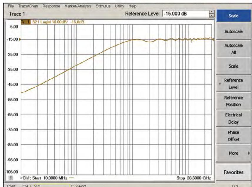
Рисунок 31 - АЧХ ответвителя измерительного порта (ответвлённый канал).
