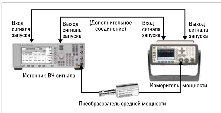
Рис. 10. Схема внешнего запуска в режиме немодулированного сигнала.
