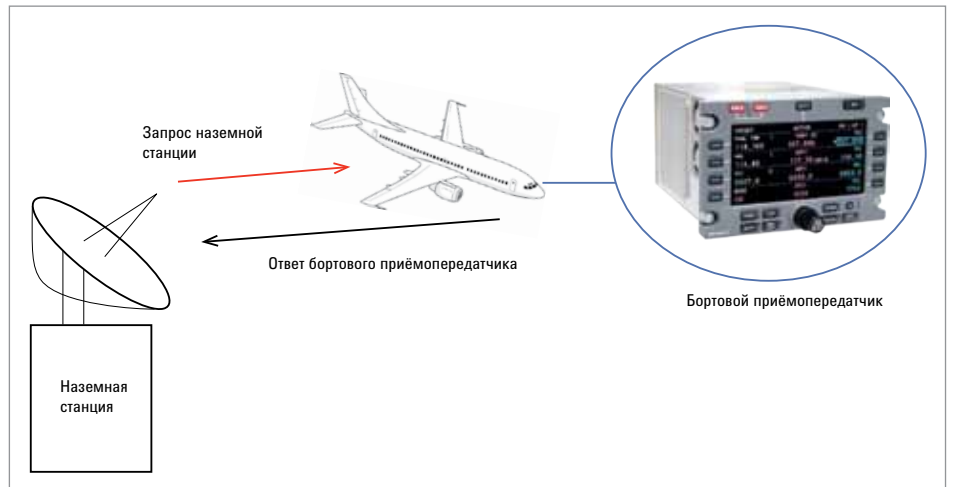
Рис. 7. Принцип работы радиолокационного ответчика.
