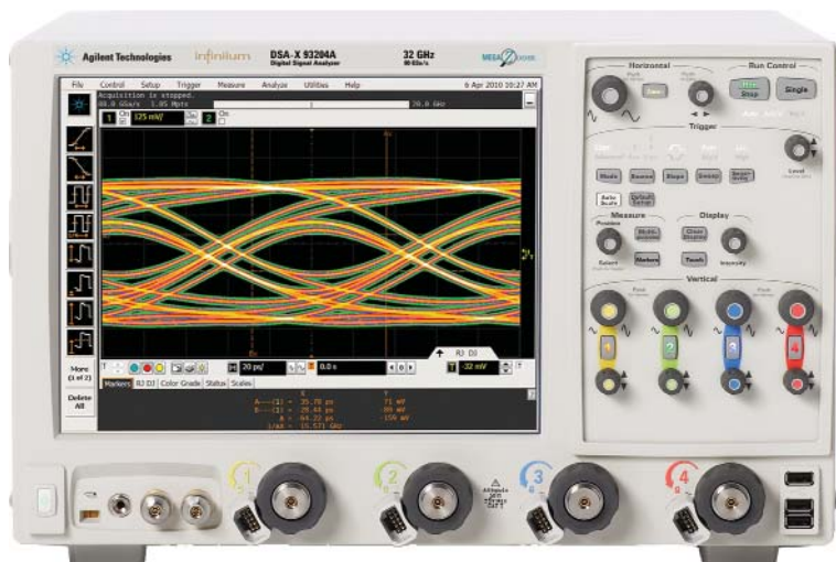
Рисунок 2 - Infiniium 90000X - самый скоростной в мире осциллограф реального времени с истинной аналоговой полосой частот до 32 ГГц.
