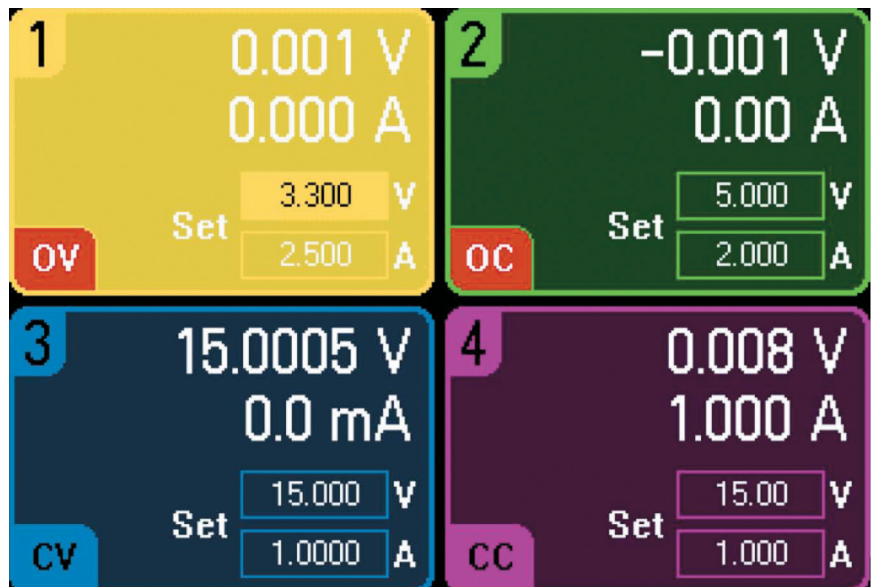
Рисунок 8: Панель источника питания, показывающая защиту от перегрузки по напряжению, защиту от перегрузки по току, режимы стабилизации напряжения и стабилизации тока.
