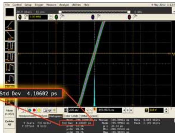
Рис. 1. Измерение джиттера генератора сигналов 33522А
