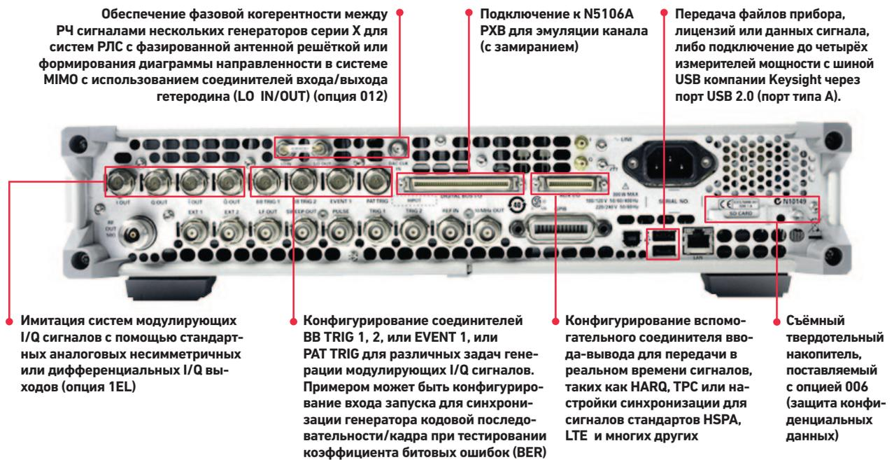
Примечание: векторные генераторы сигналов MXG и EXG серии X имеют одинаковое расположение соединителей.
