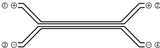
Рисунок 17. S-параметры двухпортового дифференциального устройства при однопроводном режиме воздействия.
