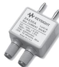
Если вы собираетесь измерять постоянные токи и переменные токи малой частоты (до 30 А и 15 А, соответственно), воспользуйтесь токовым шунтом Keysight 34330A, который представляет собой показанный выше прецизионный резистор 0,001 Ом в пластиковом корпусе, залитом эпоксидной смолой. Коэффициент преобразования шунта равен 1 мВ/А. Измеряемый ток подается на шунт через соединительные зажимы. Просто вставьте провод и затяните зажимы – что может быть проще.
