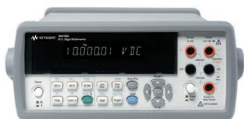
**Мультиметры Keysight 34410A и 34411A** используют метод дискретизации для измерения истинных среднеквадратических значений частотой от 3 Гц. Применение цифровых методов сокращает время установления до 2,5 с для самого медленного фильтра. Для получения наилучших результатов нужно учесть некоторые рекомендации:
