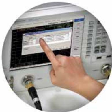
Все модели PNA оснащены сенсорным дисплеем высокого разрешения, который обеспечивает четкое изображение и простой доступ ко всем данным и трассам. Такое усовершенствование интерфейса пользователя облегчает работу и помогает быстро подготавливать сложные измерения.
