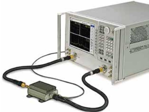
Анализатор PNA представляет собой простое в обращении одноблочное решение для быстрого и точного измерения характеристик импульсных ВЧ сигналов.
