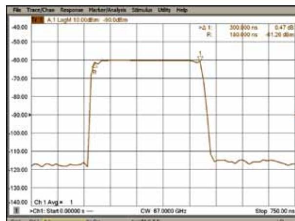
Измерение профиля импульса с помощью узкополосного обнаружения поддерживает время свипирования 300 нс по 30 точкам.
