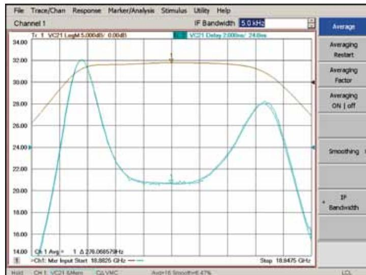
Сравнение измерений преобразователя с синхронизированным и несинхронизированным гетеродином демонстрирует превосходную корреляцию измерений. Для повышения точности при измерении устройств со встроенными гетеродинами часто используется усреднение и умеренное сглаживание.
