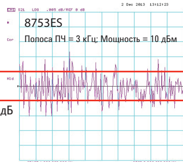
Зашумленность кривой (измерение параметра S21 перемычки, при частотах от 1 до 3 ГГц)
