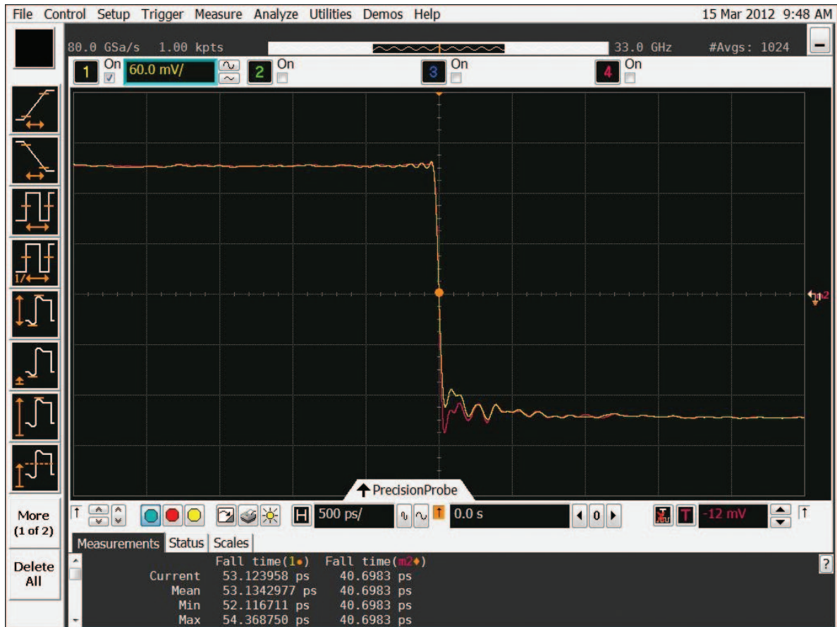
Рис. 5. Характеристики Vисточн. (красная) и Vвых (желтая) с калибровкой Vвых/Vвх.
