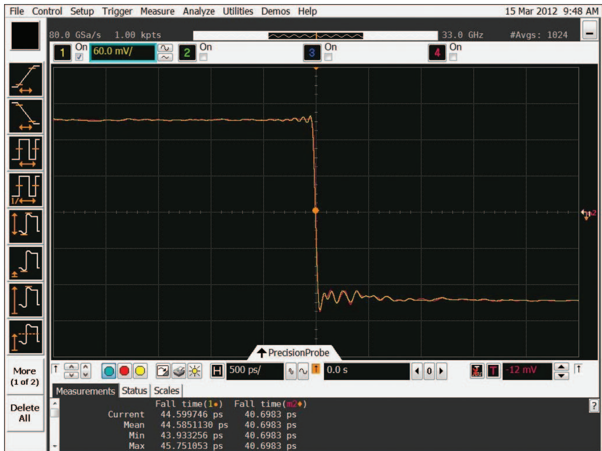
Рис. 6. Характеристики Висточн. (красная) и Ввых (желтая) с калибровкой передаточной характеристики Ввых/Висточн. для расчета импеданса в точке подключения пробника, равного 25 Ом.
