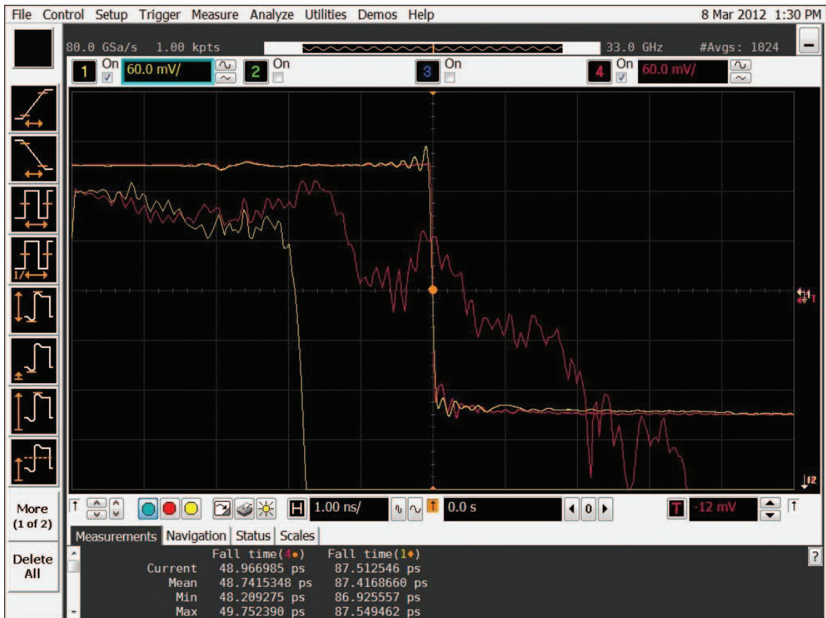
Рис. 1. Переходная и амплитудно-частотная характеристики дифференциального пробника с полосой пропускания 6 ГГц при номинальной коррекции
