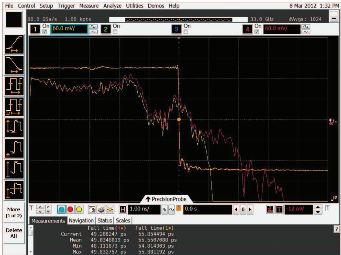
Рис. 3. Переходная и амплитудно-частотная характеристики пробника с полосой пропускания 6 ГГц, скорректированные для частоты 12 ГГц
